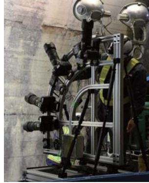
トンネル調査用システム (株)ニコンと共同開発 時速60km/h、片側撮影、精度0.3mm
