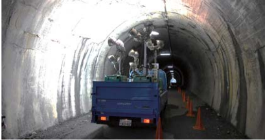
トンネル調査用システム (株)ニコンと共同開発 時速60km/h、片側撮影、精度0.3mm
