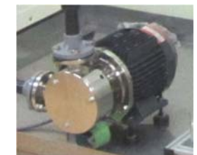
開発シール搭載の超純水用ポンプ
