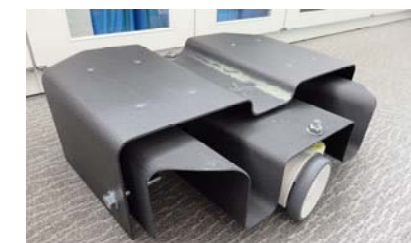
オートクレーブ成形による CFRP 製ロボットベースの試作 (基盤研究)
