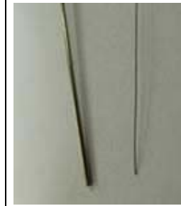
先端の比較 左: φ0.5 mm (JIS 最細品) 右: φ0.1 mm (今回開発品)
