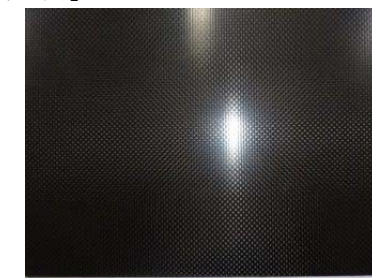
高温プレス機を活用した CFRP 平板の試作支援
