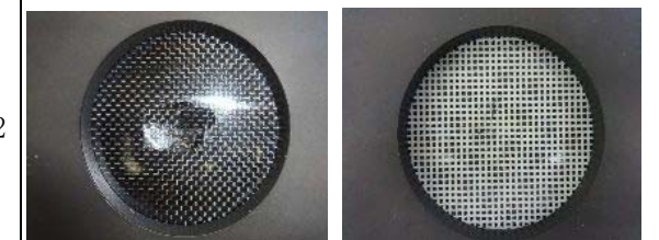
(a)従来品 (b)開発品 緩衝材を CFRP 層間にプリントし耐衝撃性を向上させた CFRP の開発
