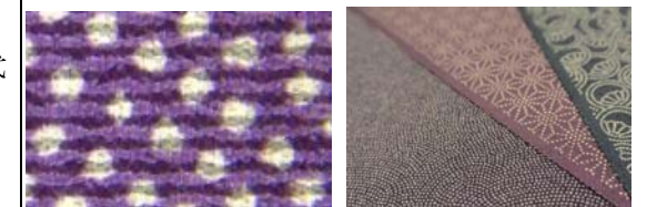
(c)レーザー加工型紙を用いた染物 東京染小紋型紙の作製技術開発 伝統産業への最新技術による貢献
