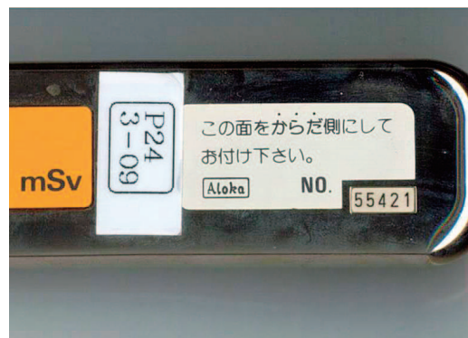
図7.11 個人被曝線量計の装着方向
