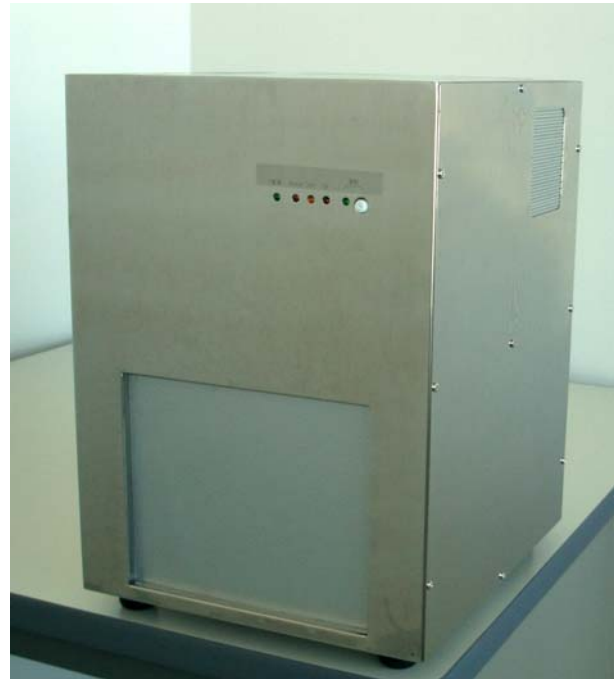
図4 開発した医療用ガス分解装置
