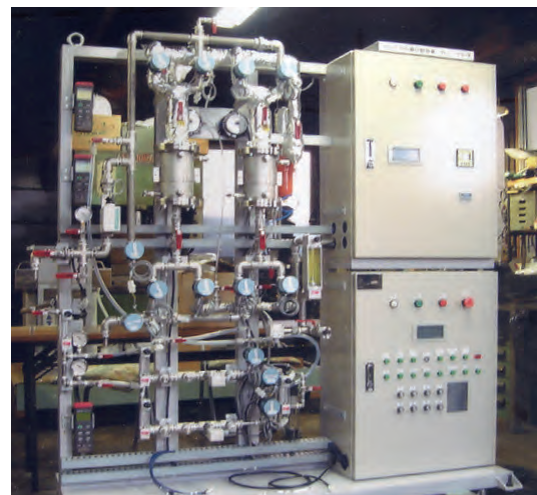
図4 開発したセンシング環境となる吸脱着試験装置
