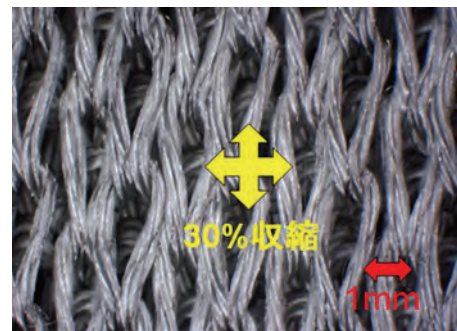
図2 収縮処理前の金属繊維編物
