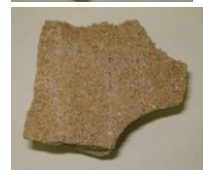
試作したガラス発泡体(混合率)
