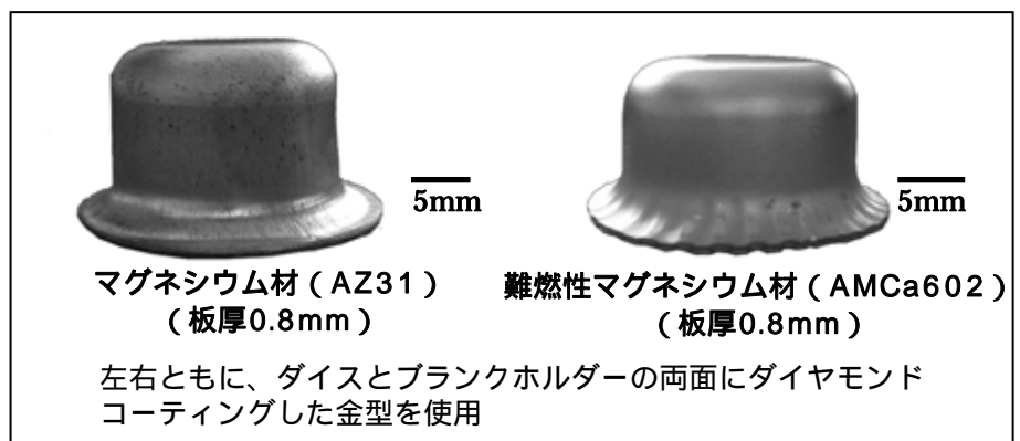
図2 通常のマグネシウム合金（左）と難燃性マグネシウム合金（右）の絞り加工品
