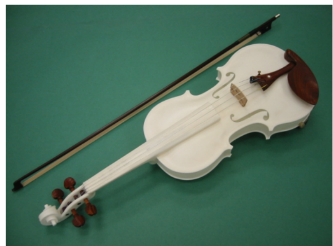
図2 RPシステムにより作製したヴァイオリン (演奏可能)
