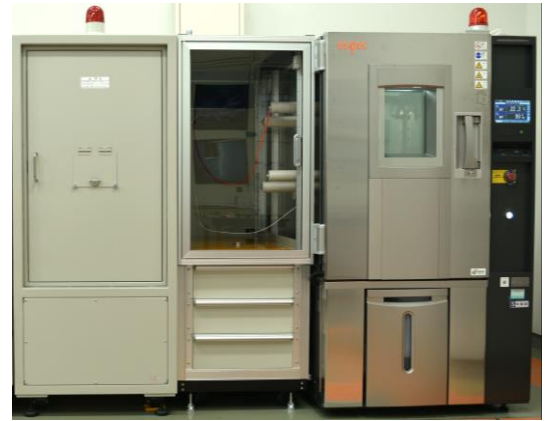
図1 装置外観 左)シールドボックス 中央)接続用ラック 右)恒温恒湿槽
