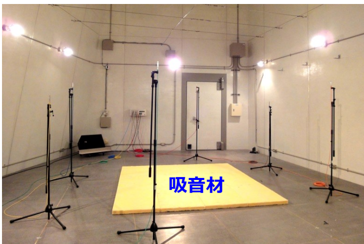
残響室（残響室法吸音率）
