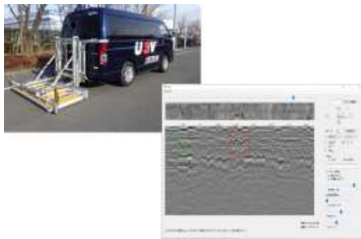
空洞探査車「U3V」と解析データ
