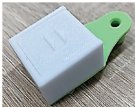
試作した IoT 機器（緑の部品によって家畜の耳に取り付ける）
