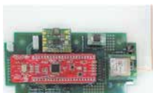
図2 着座検知センサデバイス LoRa/LoRaWAN通信切替機能、 LoRa通信出力動的切替 (20 mW・1 mW)、電波強度検知が 可能
