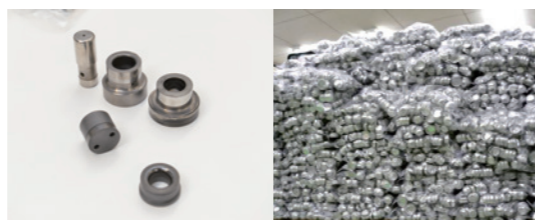
ダイヤモンドコーテッド工具 ドライで試加工した加工品の山
