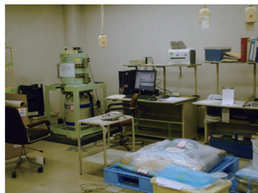
放射性物質の量の測定で使用したゲルマニウム半導体検出器
