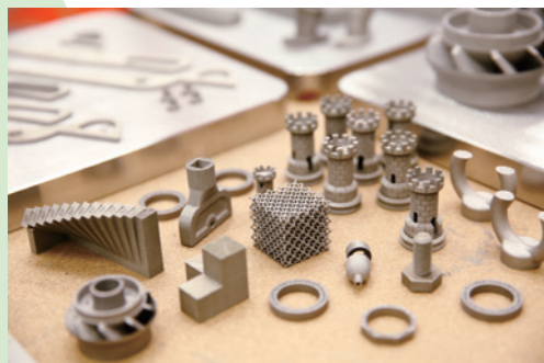
金属粉末AMによる造形品
