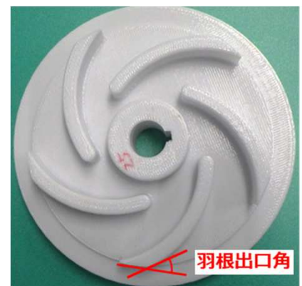
図2 改良した羽根出口角25°の羽根車 (一般的には22.5°で設計)
