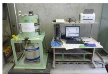
放射性物質の量の測定で使用した ゲルマニウム半導体検出器
