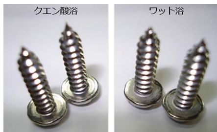
光沢剤添加量を規定量の1/4で作製したニッケルめっきのネジ。クエン酸浴は少量の光沢剤で十分な光沢が得られる。
