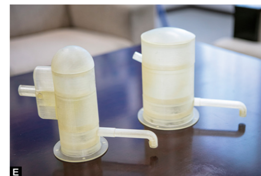
A 同社では途上国での手動ポンプ普及事業にも適進してきた B C 都産技研が作成したデザイン案の CAD イメージ D 吐水口とハンドルの角度を自由に変えられる構造の図解 E デザイン案を基に 3D プリンターで作成した模型 F 完成した手動ポンプ
