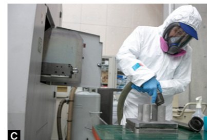
A トポロジー解析の確認画面 B 有限要素法解析 (CAE) の確認画面 C 金属粉末 AM 装置 (3D プリンター) での試作品製作 D 単体試験の様子 E チタン合金製の最新型アダプター。3D レーザー加工機による刻印も施されている
