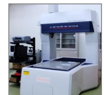
長さ(形状測定器)の JCSS として国内で唯一認定を取得している三次元座標測定機
