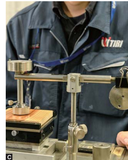
A 開発した木製ホワイトボード「きえすぎくん」 B オフィスなどに導入 C 表面摩耗試験により、一万回擦ってもかき消しできることを確認 D 促進耐試験で耐候性を評価 E 綺麗な木目が特徴の多摩産の木材を使用
