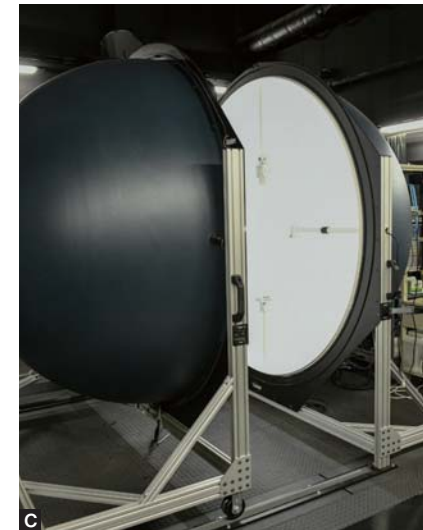
A 開発した「再調整可能な高演色LED照明」 B 白色LED+3色LEDによる画期的手法 C 球形光束計にて分光放射束を測定 D 演色性の評価 E 都産技研と首都大学東京の共同研究成果
