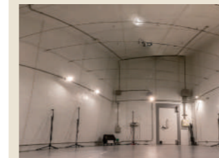
残響室 吸音率測定・音響パワーレベル測定などを行います。
