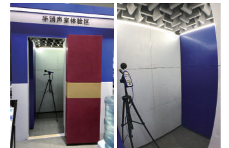
展示会に出品した簡易ブース 表面に金属繊維板を採用したことで、塗装が可能になった。
