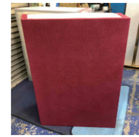
試作した吸音ユニット 施工しやすさを追求し、外形寸法は 1 × 0.7 × (厚さ) 0.3 m で質量は約 15 kg とした。
