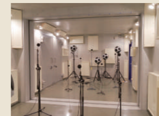
結合残響室 (タイプII 試験室) 遮音材や建具、床材などの遮音性能を測定できます。
