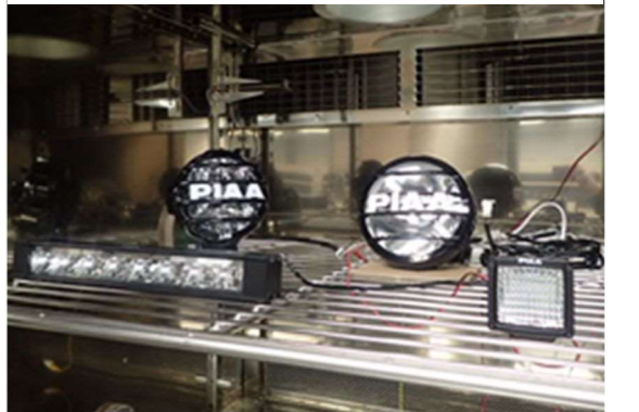
減圧恒温槽で高地環境を模擬し性能確認
