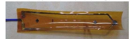
特殊形状の熱電対を対象に熱起電力を評価
