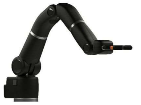
ロボットアームの製品外形 電動車椅子等に取付・取外しが可能
