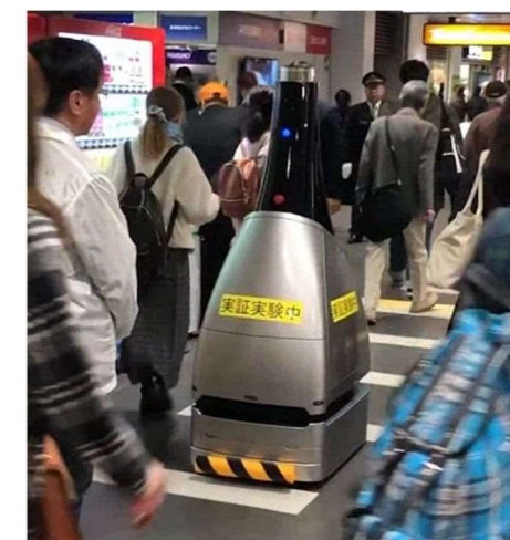
西武新宿駅での警備ロボットの実証実験 AI 監視カメラで異常検知し、急行
