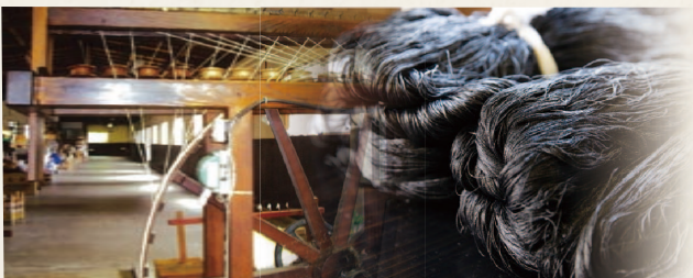
(左)国内でも数少ない「張り織り式八丁撚糸機」。森氏自身がメンテナンスや修理をしながら使い続けている。(右)黒八丈は染めの回数を重ねた分だけ、より深い黒に染められていく。
