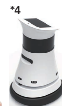
*4 Siriusbot (シリウスロボット) 商用施設パルコで実証実験が行われ、昼間は店舗案内、夜間はRFIDによる在庫棚卸しの検証がされました。
