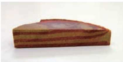
図3. ゆがみが生じた縞模様の再生べっ甲
