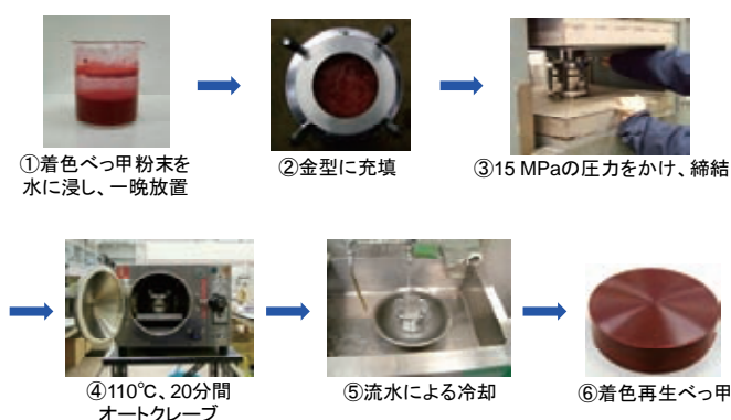
図1. 着色した再生べっ甲の作製の流れ
