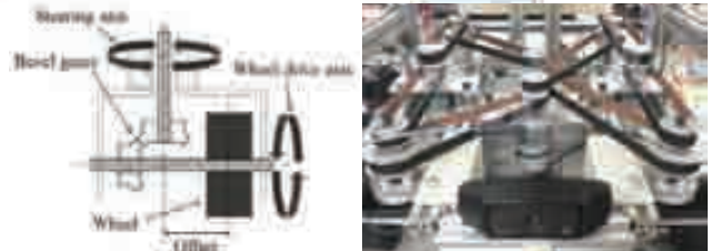
全方位移動機構試作2号機（駆動2・操舵2）
