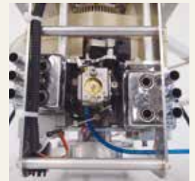
燃料噴射装置にはキャブレター方式を採用。海外メーカーと技術提携を行い、このドローン専用エンジンに最適なインジェクション方式の開発も進めている。
