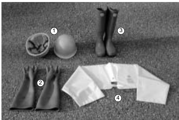
写真1 絶縁保護具の例 安全帽、手袋、長靴、絶縁衣です。
