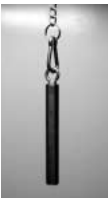
写真1 線源外観 (模擬線源) ステンレス製管(22mm)の内部に ^{60}\text{Co} が詰められている。
