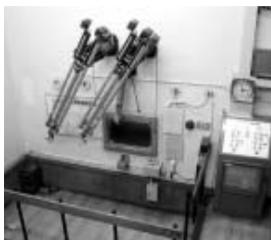
写真2 コバルト照射施設線源操作室 中央窓の向こう側に照射室、左側壁の向こう側に照射室がある。中央窓上部の構造物は遠隔操作用マジックハンド。
