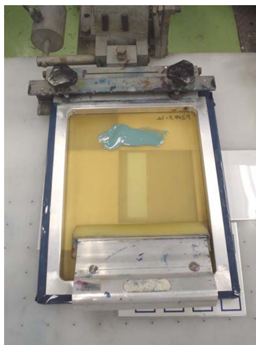
図3 ガラス基板上へのオーバーコート膜形成印刷例 (図のペーストには無機顔料は混合してない)
