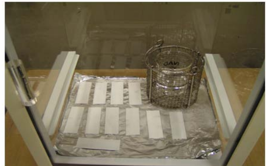
写真1 塗装板からの防かび剤の放散量の測定
