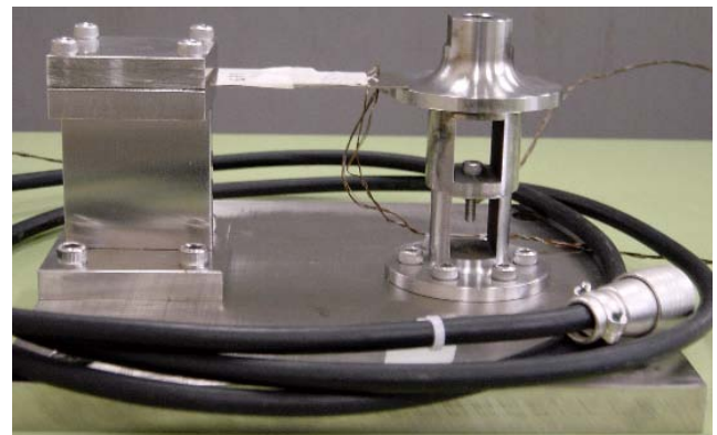
図3. 変位計とクリープ試験用ジグ
