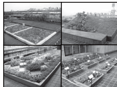
写真3 屋上緑化実証試験 (火山灰利用研究会)
