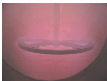
図1 窒素によるプラズマ発光
