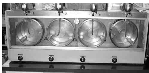
図2 試験用4連ドラム
