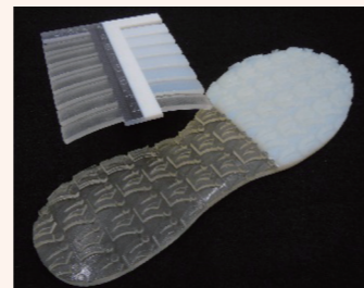
ゴムライク樹脂硬さサンプル (上) ゴムソールサンプル (下)
