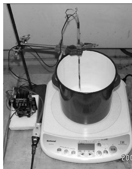
図 5. バッチ式蒸発器の自動切断システム
