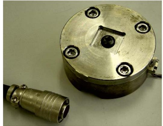
図5. 開発したロードセル
