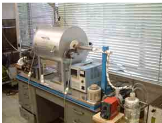
図1 活性炭製造炉
