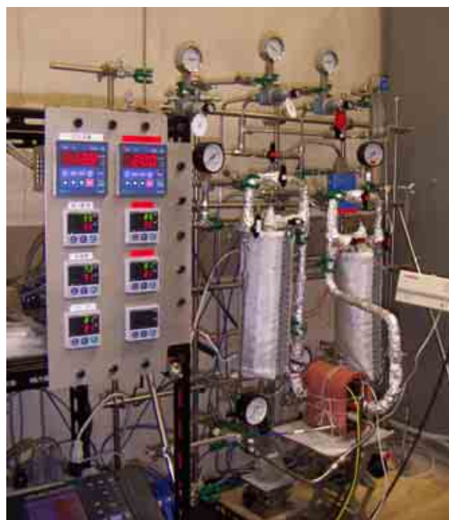
図1 自作した燃料電池評価装置
