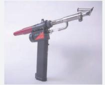
ノズルパーツを金属 AM で試作
