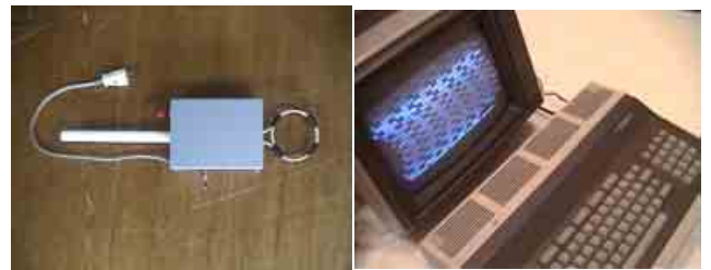
図 10 試作ノイズシミュレータと電界照射実験
