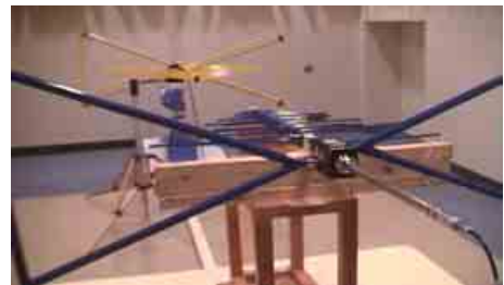
(a) 規格測定用大型アンテナ(手前)の感度測定
