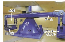
遠心模型実験装置 石垣モデル解析手法の妥当性確認のために実証実験を実施
