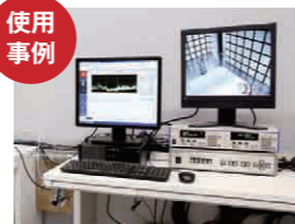
電波暗室の電界均一性測定
