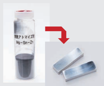
開発した粉末冶金用マグネシウム合金粉 特開2014-231638
