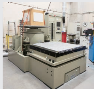
大型振動試験機による包装貨物の試験例
