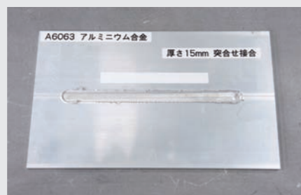
摩擦攪拌接合による アルミニウム合金厚板の接合例
