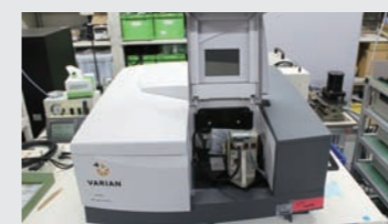
フーリエ変換赤外分光光度計 (FT-IR) 各種材料などの分光放射率・反射率・透過率測定
