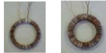
直接コイル巻き ケースに入れてコイル巻き 図1 コイル巻きをしたリング試料の様子
