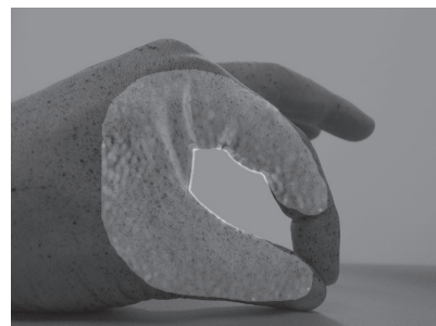
図3. 画像相関法により得た変位勾配の分布 (実際には色によって勾配の大きさを表示)
