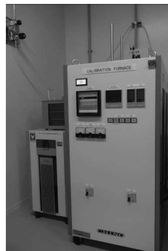
図1. 銅の凝固点実現装置
