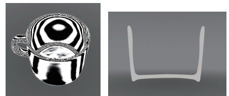
図 3. 3D デジタイザによる形状解析
