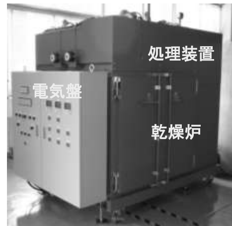
図2 処理装置乾燥炉一体型試作機(触媒燃焼式)
