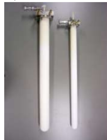
図 1 左：高精度共晶点セル 右：実用型共晶点セル
