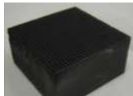
図1 開発した Ce,Co 系ハニカム型触媒
