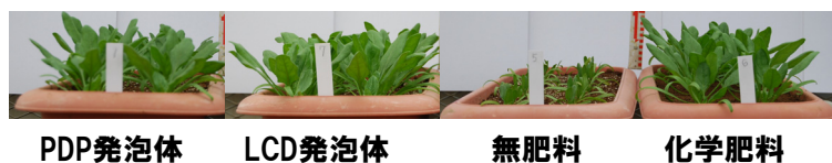
図 1. 薄型テレビガラス発泡体の肥料試験状況
